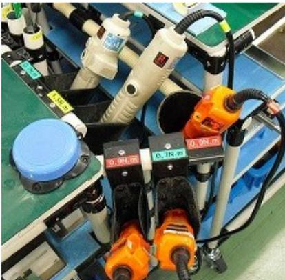
作業者は部品トレーの色とトルクドライバーに付いているカバーの色を合わせるだけで、単純に作業ができる
