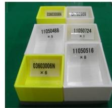
部品トレーに入れるネジの締め付けトルクは、トレーの色と、トルクドライバーの色で対応している
