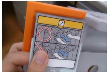
プリンターの本体カバーに貼るデカルの位置決め作業を行う時に製品本体カバーの勾配に合わせて、治具側にも勾配を付けたものが、作業しやすいのだが、切削で造ると加工費が高く、実現できなかった。
