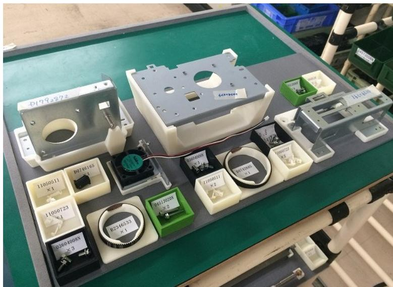
一つのユニットを組み立てる時に、必要な部品一式と組み立て用治具を、1プレートにセットした台車が、作業者の前に届く。
