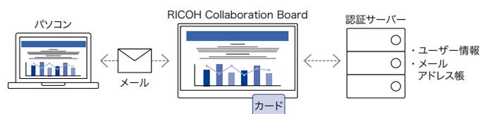
Active Directory、LDAP、EMPOWERING DIGITAL WORKPLACESプラットフォームと連携し、RICOH Collaboration Board利用の際にICカードによるユーザー認証(利用者特定/制限)を行なうことができます。RICOH Collaboration Boardに標準で埋め込まれたNFCリーダーにICカードをタッチするだけでログインが可能です。
