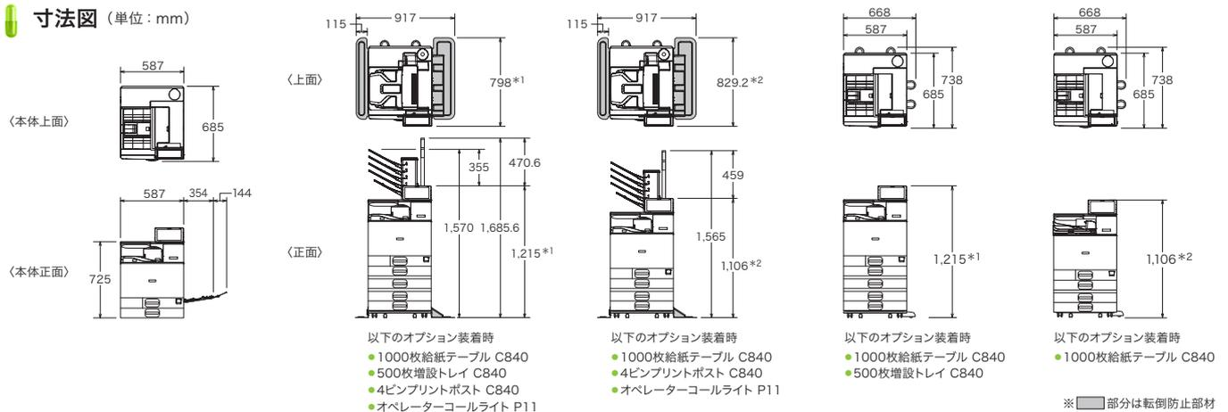
\*1 4ピンプリントポスト C840装着時の操作部最大角度90°(垂直)の時。 \*2 操作部角度55°の時。
