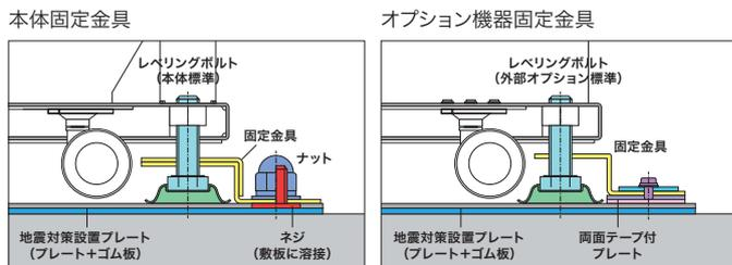
機器とプレートを固定し、設置プレート底面にゴムシートを貼り付けることでプロダクション・プリンティング製品の移動・転倒を抑止。プロダクション・プリンティング製品本体部と設置プレートをネジで固定し、外部オプションと設置プレートをテープで固定します。
