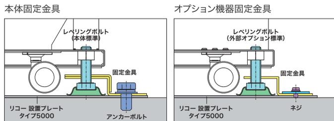
床にアンカーを打ち込むことによってプロダクション・プリンティング製品の移動・転倒を抑止。プロダクション・プリンティング製品本体部をアンカー固定し、外部オプションと設置プレートをネジで固定します。
