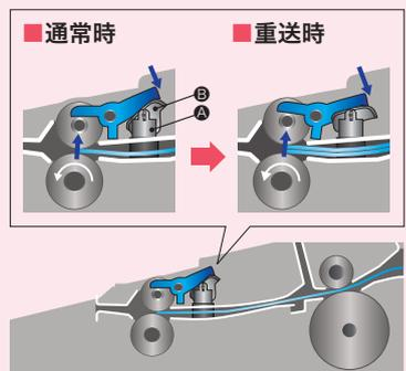
紙厚レバー②の回転量をレバー式エンコーダセンサー(重送センサー)①で検知し、重送を判定している。
